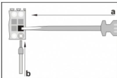
a) inserire il cacciavite senza ruotarlo
