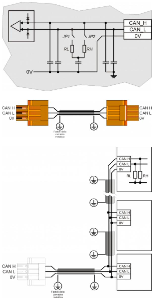
Esempio di collegamento CAN BUS.
