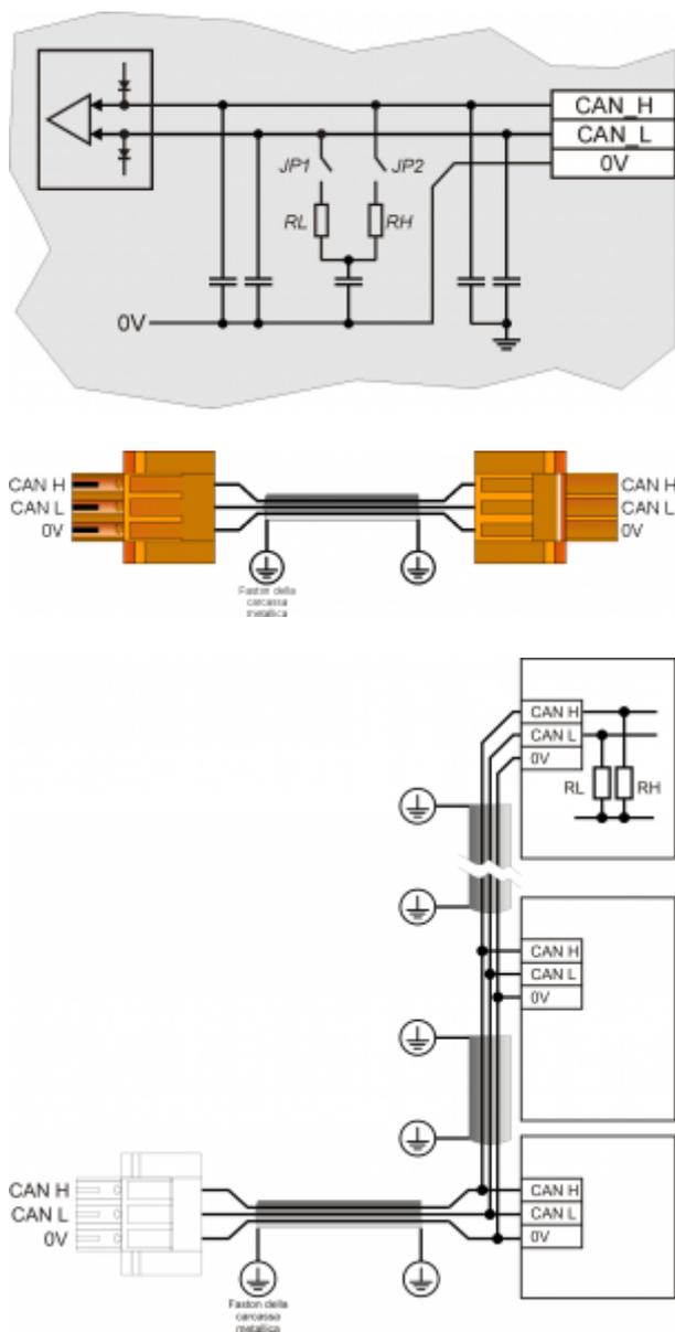
Esempio di collegamento CAN BUS.
